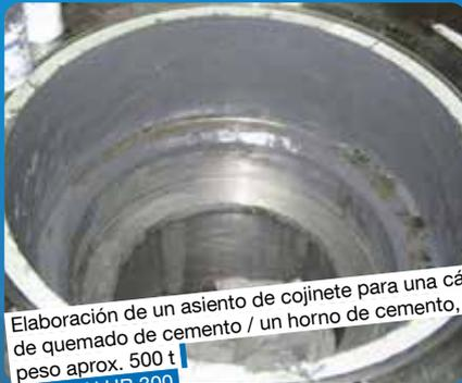
Elaboración de un asiento de cojinete para una cámara de quemado de cemento / un horno de cemento, peso aprox. 500 t
