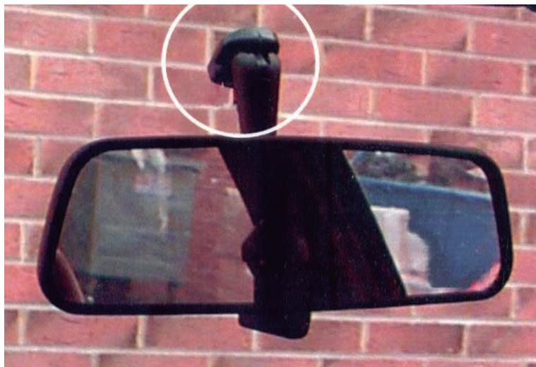
El kit de reparación del retrovisor interior contiene un adhesivo anaeróbico con alto nivel de fijación así como una malla impregnada de nylon que actúa, por un lado, como refuerzo de la base del retrovisor y otro como catalizador del adhesivo. Está desarrollado especialmente para unir metal o plástico a superficies de cristal. Su alta viscosidad hace posible que pueda utilizarse en vertical.
