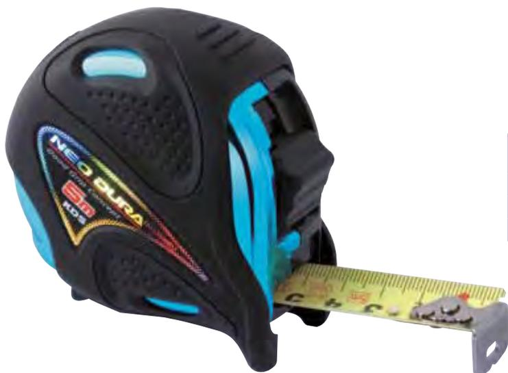
Cinta con doble recubrimiento **Dura Coat** y escala de graduación en ambas caras para facilitar la medición en alturas. Exclusivo sistema **KDS** de doble freno automático. Al mover el freno hacia abajo, la cinta se bloquea totalmente. Al mover el freno hacia arriba la cinta se recoge suavemente. Uña con 4 remaches y protector exclusivo. Gracias a su grip antideslizante se adecua perfectamente a la palma de la mano.
