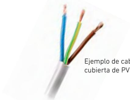
Ejemplo de cable de H05VV-F 3Gx1,5 mm (cable con aislamiento y cubierta de PVC, flexibles, 3 conductores de sección 1,5 mm<sup>2</sup>)
